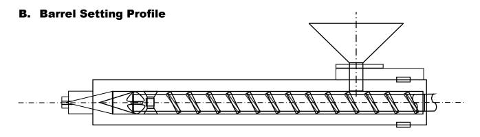
**MAX**(F) 550<sub>NOZZLE</sub> 560<sub>FRONT</sub> 550<sub>MIDDLE</sub> 510<sub>REAR</sub> MIN(F) 510 540 520 480
