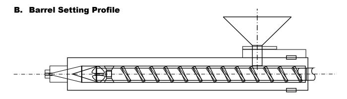
**MAX**(F) 540<sub>NOZZLE</sub> 540<sub>FRONT</sub> 540<sub>MIDDLE</sub> 540<sub>REAR</sub> MIN(F) 520 520 520
